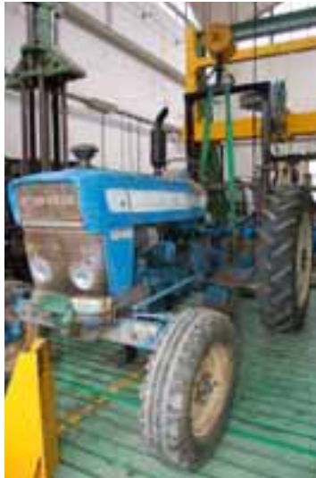
Figura 11. Struttura di protezione per trattori a ruote a carreggiata standard modello Ford Major 4000 e simili
