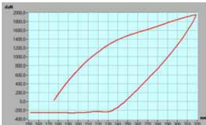
Figura 10. Spinta laterale lato sinistro
