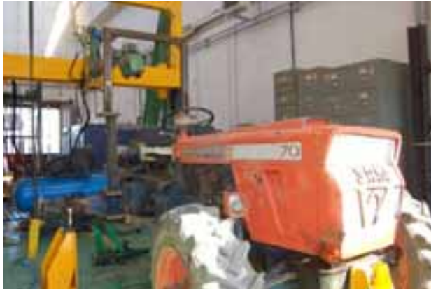
Figura 10. Struttura di protezione per trattori a ruote a carreggiata standard modello Same Leone 70 e simili
