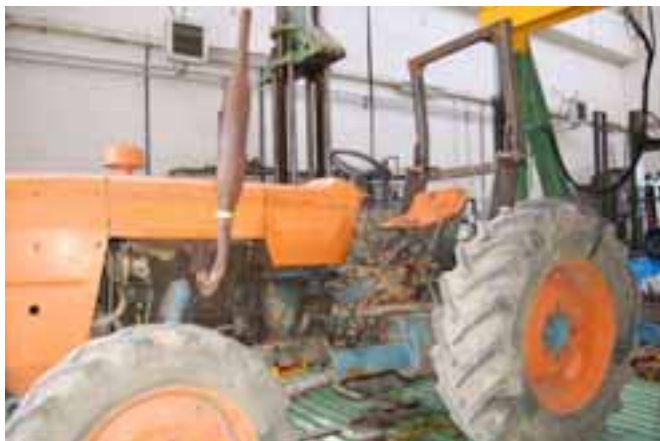
Figura 17. Struttura di protezione per trattori a ruote a carreggiata standard modello OM 615 e simili
