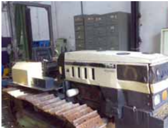
Figura 12. Struttura di protezione per trattori a cingoli modello Lamborghini C674 e simili
