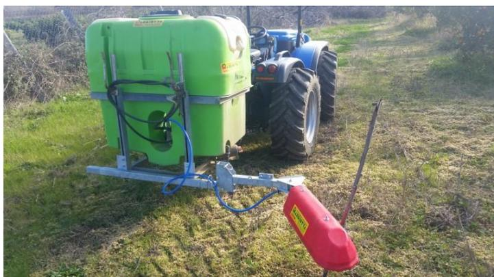
Le barre per il diserbo sottochioma delle colture arboree possono essere dotate o meno di schermatura destinata a limitare la deriva della soluzione irrorata. La discriminante per classificare una barra schermata o non schermata sono gli ugelli a cielo aperto che sono tipici delle sole barre non schermate.
