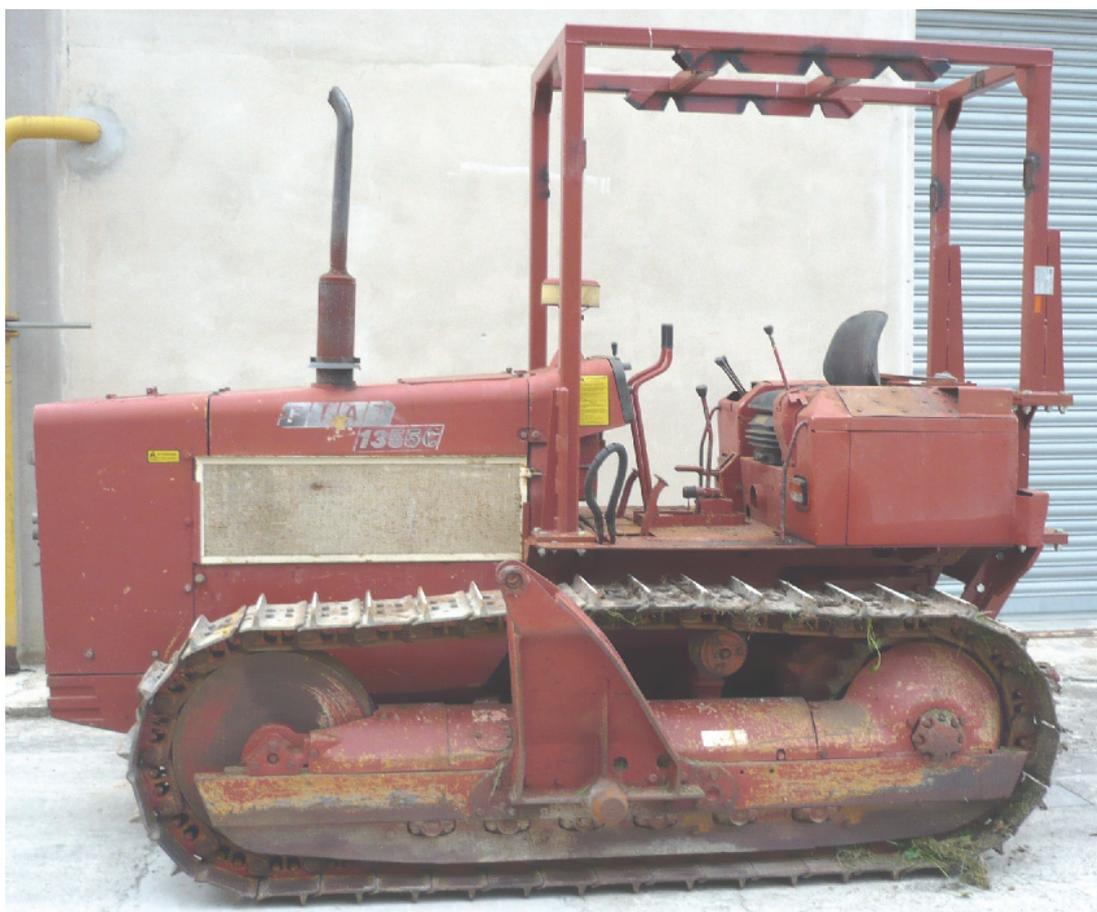
**STRUTTURA DI PROTEZIONE A QUATTRO MONTANTI
