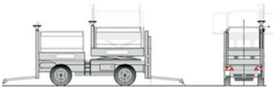
Esempio di macchina agricola raccogli frutta con piattaforme multiple e comandi singoli
