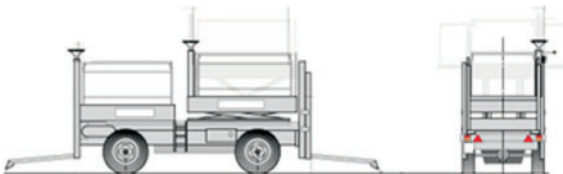
Esempio di macchina agricola raccogli frutta con piattaforme e comandi multipli
