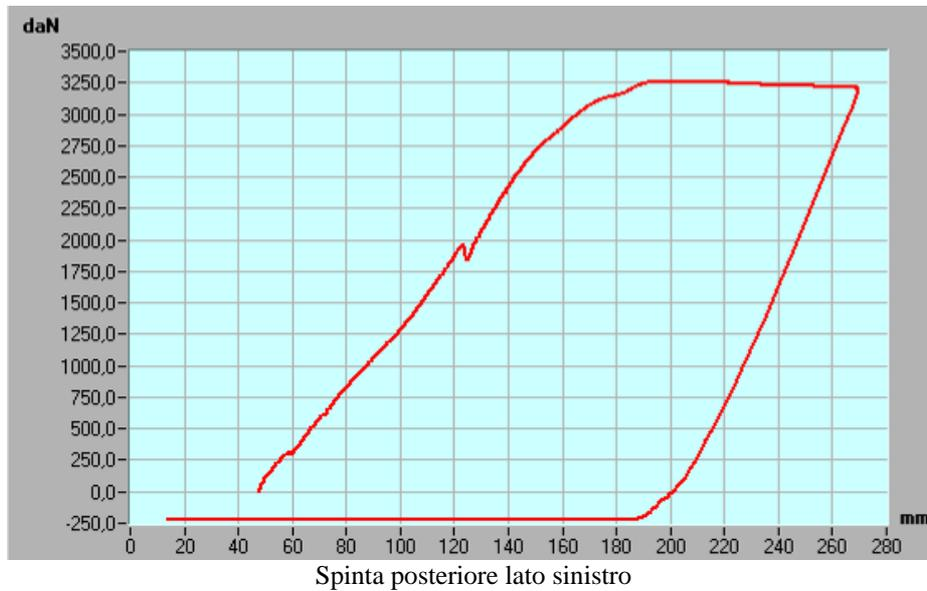
**Primo schiacciamento:** Alla struttura in prova è stato applicato un carico di circa 72730 N. Le deformazioni registrate sono state di 13,2 mm verso il basso per il lato destro e 28,7 mm verso il basso per il lato sinistro.
