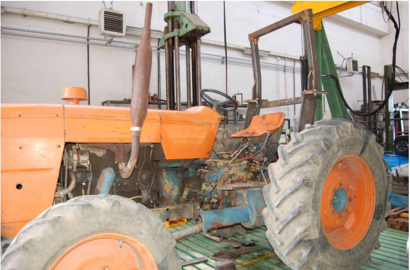
**STRUTTURA DI PROTEZIONE A DUE MONTANTI POSTERIORE
