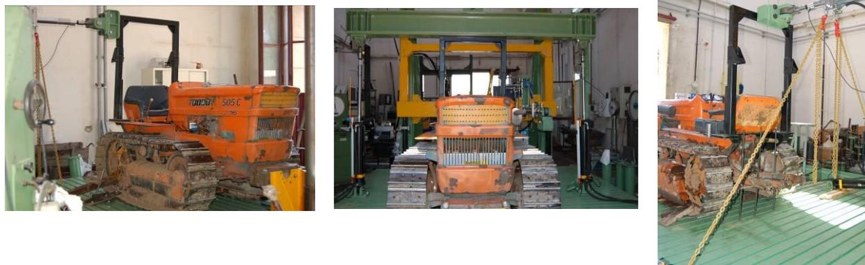
Figura 11. Fasi della prova. Da sinistra verso destra: spinta laterale, schiacciamento e spinta longitudinale
