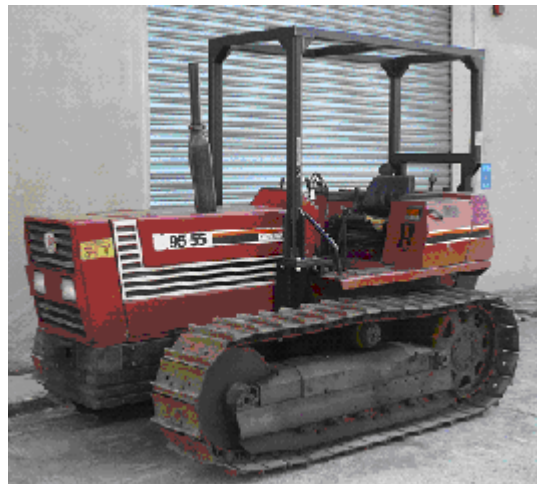
Figura 22. Struttura di protezione per trattori a cingoli modello Fiat 955 e simili
