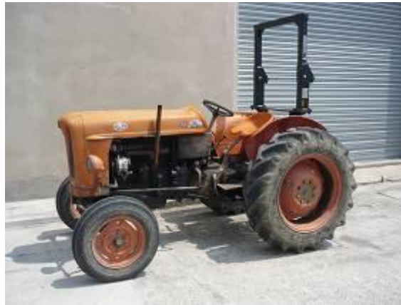
Figura 13. Struttura di protezione per trattori a ruote a carreggiata standard modello Fiat 411R e simili
