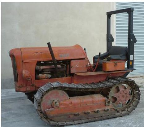
Figura 17. Struttura di protezione per trattori a cingoli modello Fiat 411C e simili
