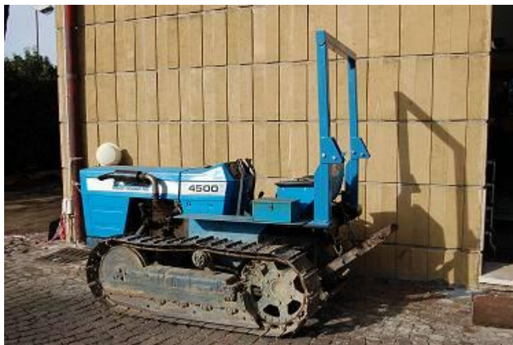
Figura 14. Struttura di protezione per trattori a cingoli modello Landini 4500 CL e simili
