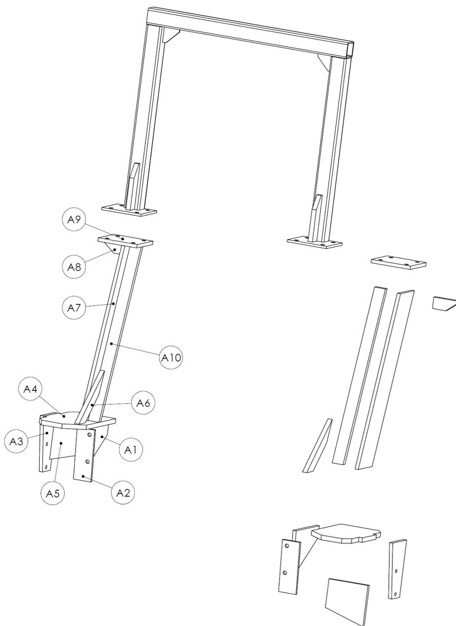
Figura 1. Telaio a due montanti posteriore per trattori a ruote a carreggiata standard modello Fiat 450 DTH e simili (Fiat 350 DT)
