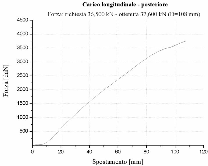
Figura 20. Risultati della prova di spinta longitudinale
