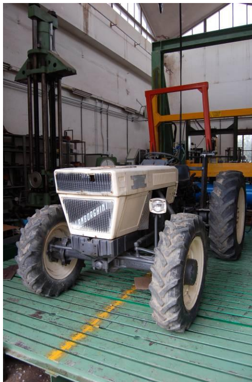
Figura 13. Struttura di protezione per trattori a ruote a carreggiata standard modello Lamborghini R235 DT e simili
