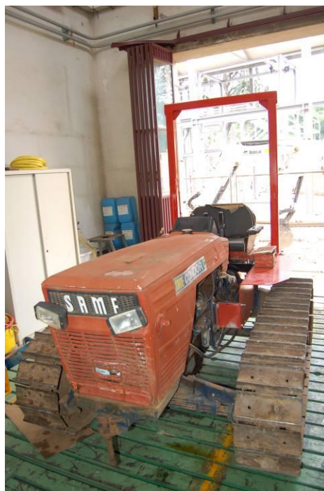
Figura 14. Struttura di protezione per trattori a cingoli modello Same Condor C e simili
