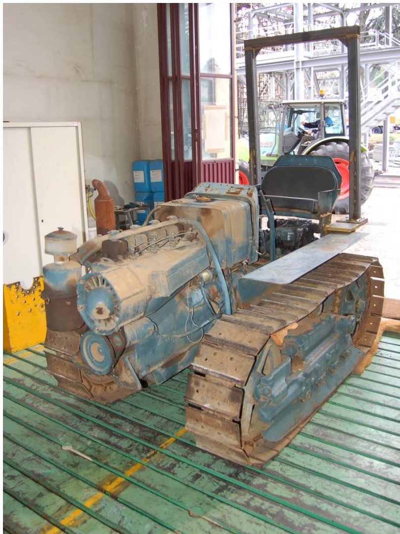
Figura 9. Struttura di protezione per trattori a cingoli modello Lamborghini 4 CTL e simili
