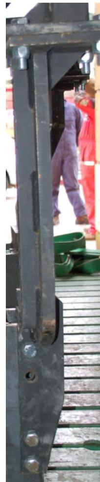
Figura 7. Dispositivo di attacco anteriore lato sinistro (a sinistra) e dispositivo di attacco posteriore lato destro (a destra).
