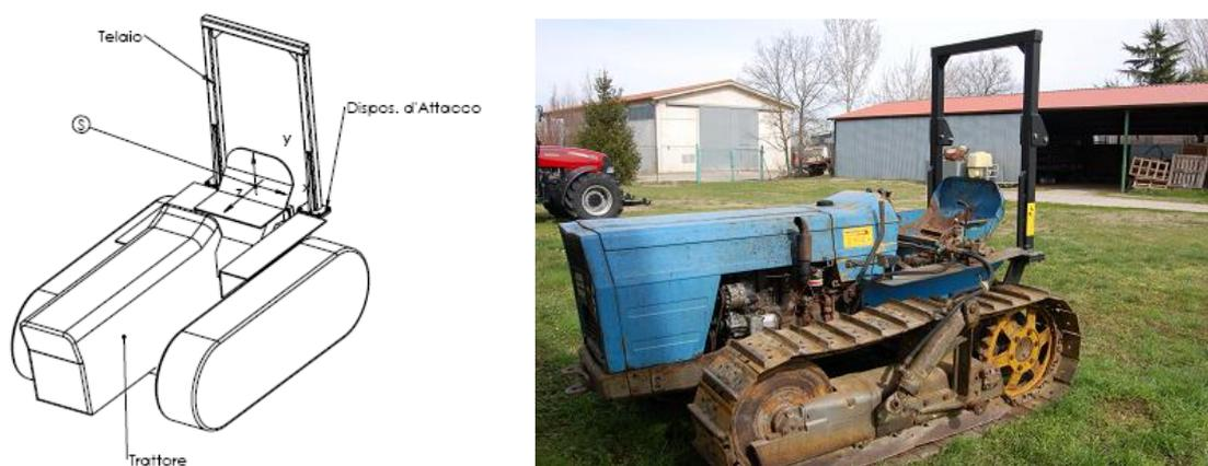
Figura 10. Struttura di protezione per trattori a cingoli modello Landini 6500C e simili
