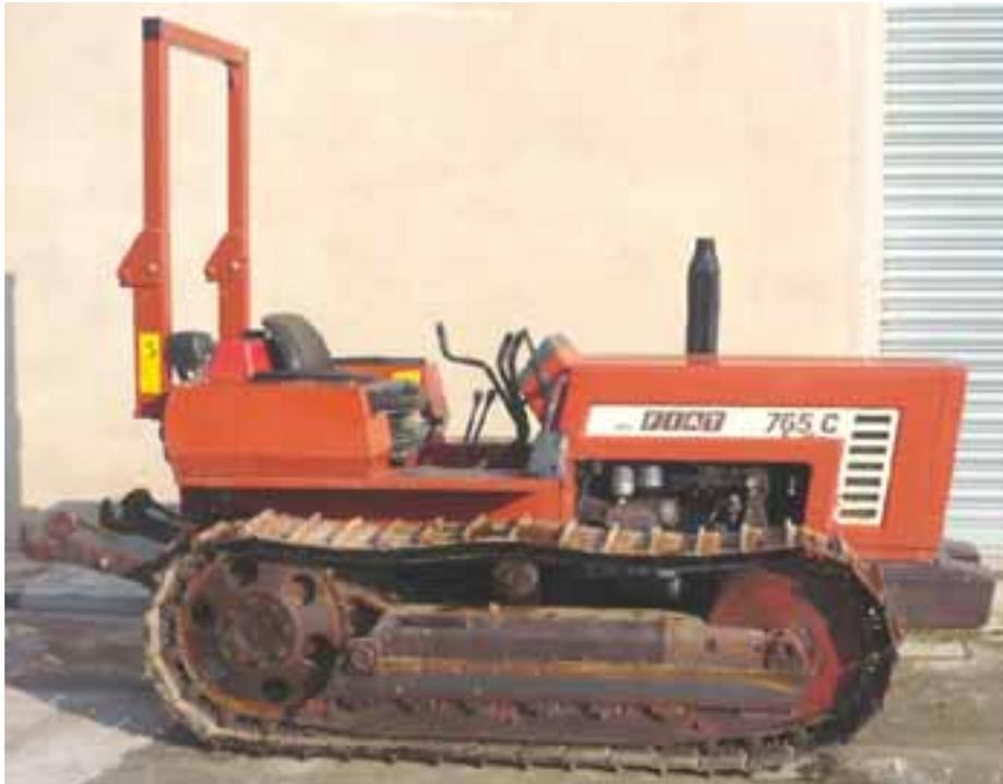
**STRUTTURA DI PROTEZIONE A DUE MONTANTI
