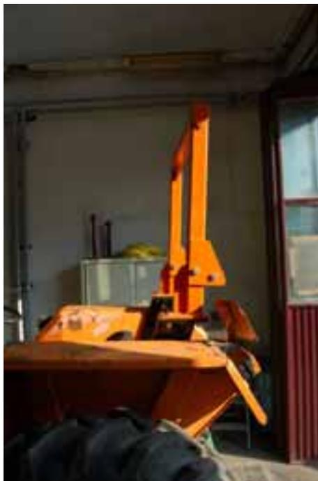
**STRUTTURA DI PROTEZIONE A DUE MONTANTI POSTERIORE
