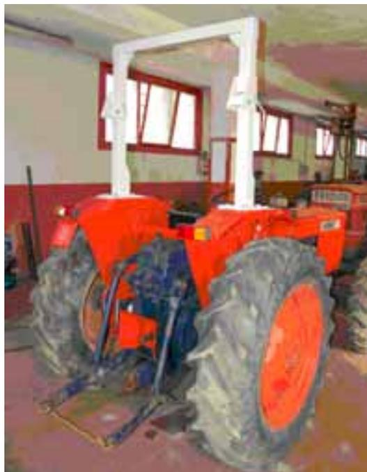
**STRUTTURA DI PROTEZIONE A DUE MONTANTI POSTERIORE
