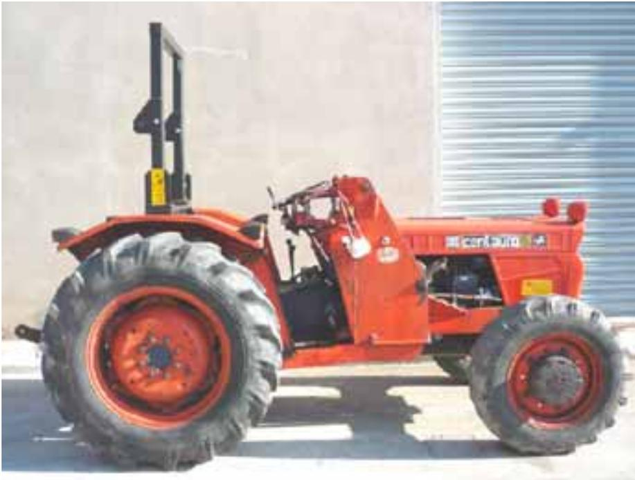
**STRUTTURA DI PROTEZIONE A DUE MONTANTI POSTERIORE
