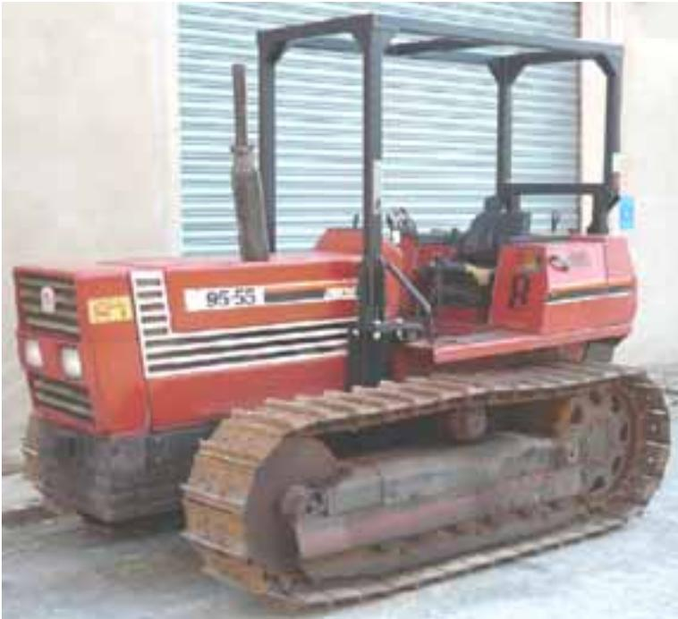
**STRUTTURA DI PROTEZIONE A QUATTRO MONTANTI
