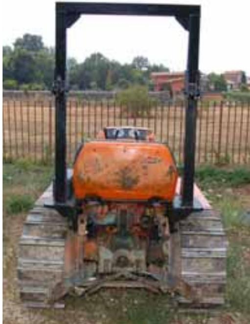
**STRUTTURA DI PROTEZIONE A DUE MONTANTI POSTERIORE
