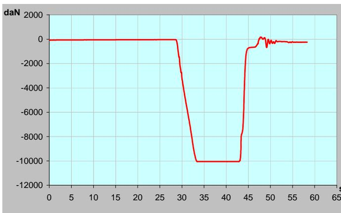
Figura 13. Risultati della prova di schiacciamento. Forza applicata
