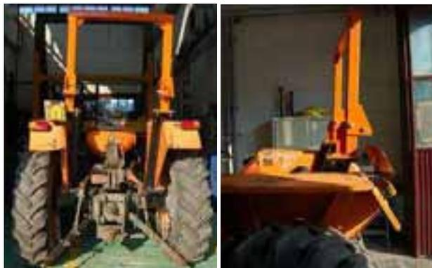
Figura 13. Struttura di protezione per trattori a ruote a carreggiata standard modello Fiat 450 DTH e simili (Fiat 350 DT)
