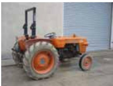
Figura 14. Struttura di protezione per trattori a ruote a carreggiata standard modello Fiat 415R e simili
