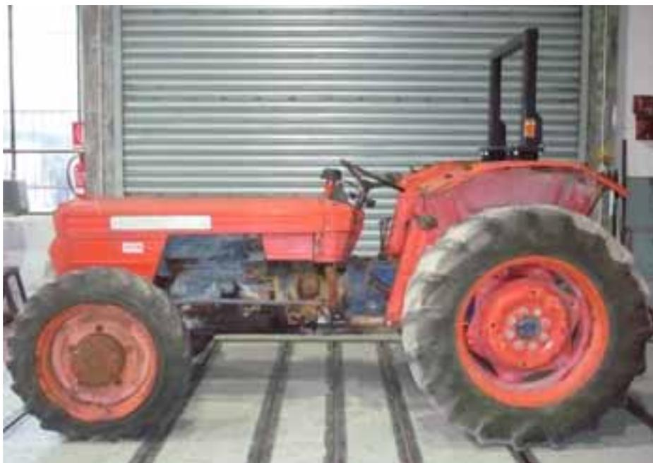
**STRUTTURA DI PROTEZIONE A DUE MONTANTI POSTERIORE
