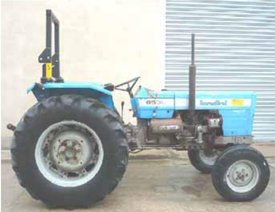
**STRUTTURA DI PROTEZIONE A DUE MONTANTI POSTERIORE
