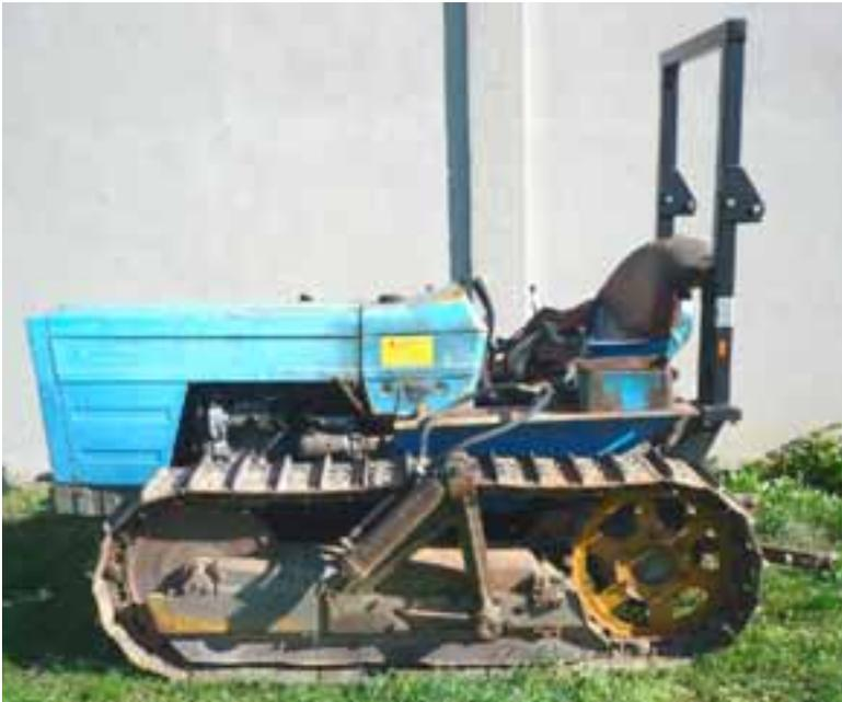
**STRUTTURA DI PROTEZIONE A DUE MONTANTI POSTERIORE
