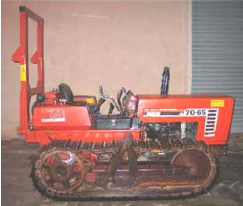
**STRUTTURA DI PROTEZIONE A DUE MONTANTI POSTERIORE
