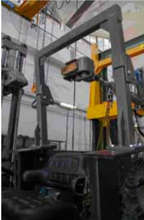
**STRUTTURA DI PROTEZIONE A DUE MONTANTI POSTERIORE
