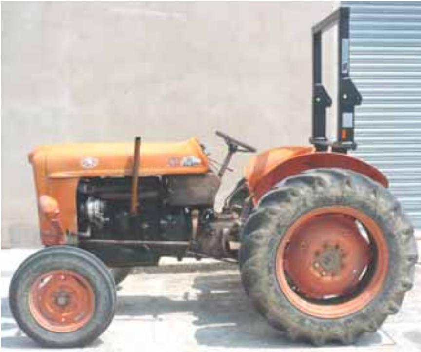
**STRUTTURA DI PROTEZIONE A DUE MONTANTI POSTERIORE
