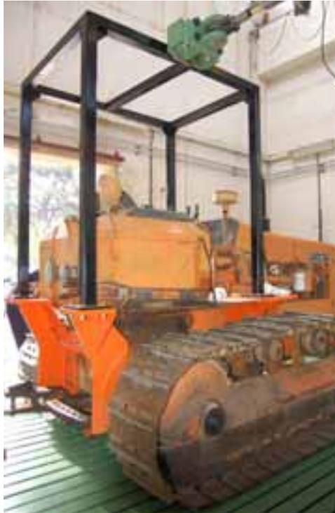
**STRUTTURA DI PROTEZIONE A QUATTRO MONTANTI
