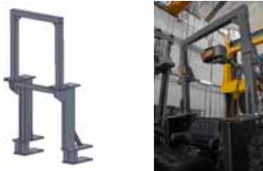
Figura 12. Struttura di protezione per trattori a ruote modello Fiat 640 e simili
