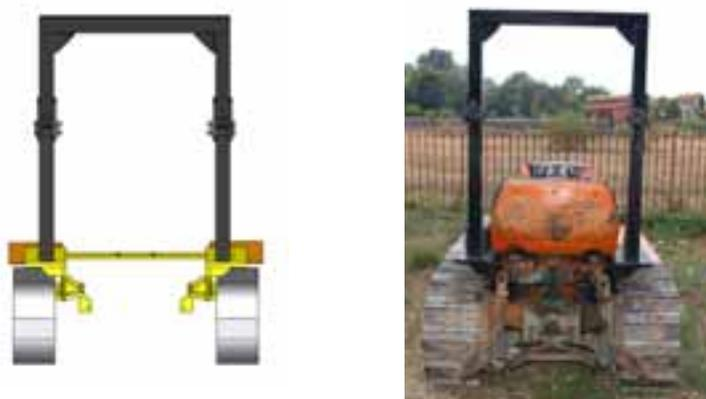
Figura 10. Struttura di protezione per trattori a cingoli modello 605 e derivati
