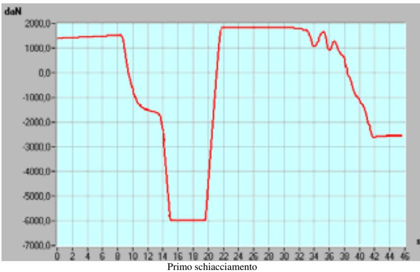
**Spinta laterale:** il carico è stato applicato sul lato sinistro della struttura di protezione. In figura si riporta il grafico forza vs. deformazione in cui il superamento dell'energia si è ottenuto in corrispondenza di una deformazione massima di circa 220 mm con una deformazione residua di circa 102 mm.
