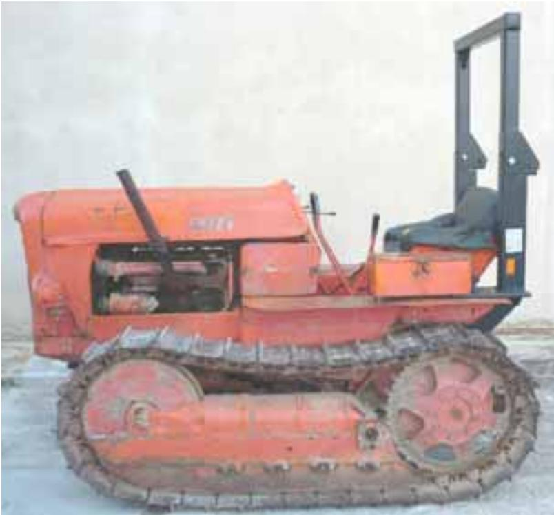
**STRUTTURA DI PROTEZIONE A DUE MONTANTI POSTERIORE
