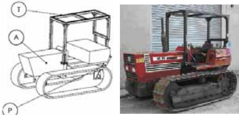
Figura 22. Struttura di protezione per trattori a cingoli modello Fiat 955 e simili
