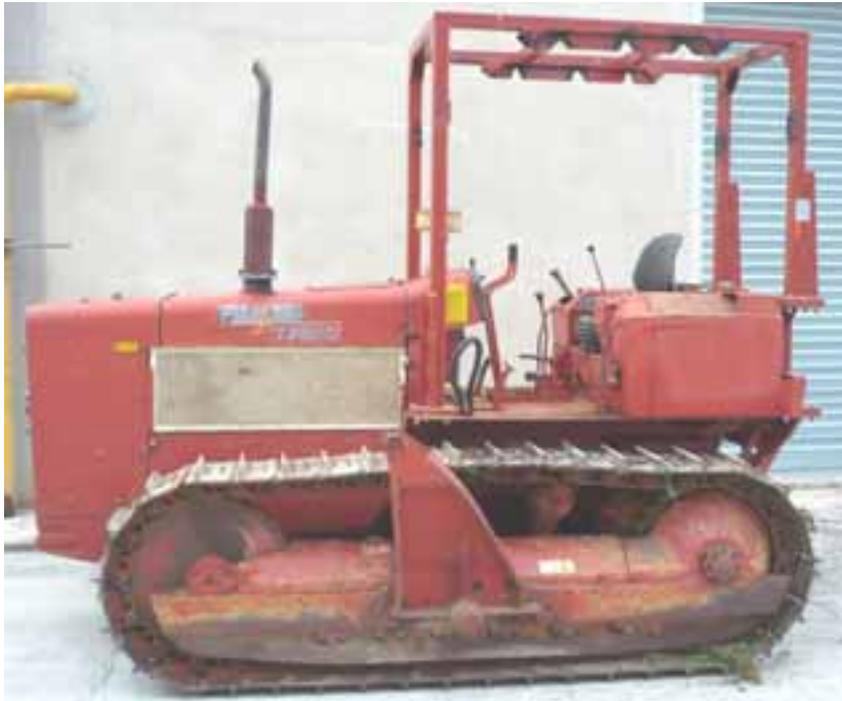
**STRUTTURA DI PROTEZIONE A QUATTRO MONTANTI
