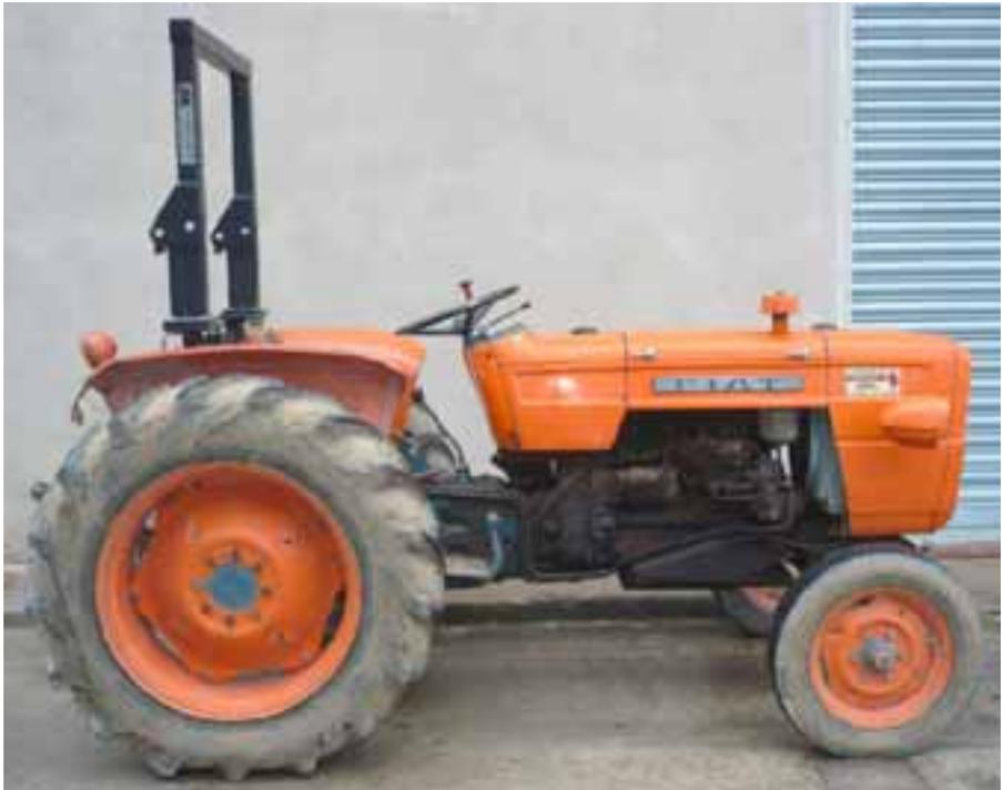
**STRUTTURA DI PROTEZIONE A DUE MONTANTI POSTERIORE
