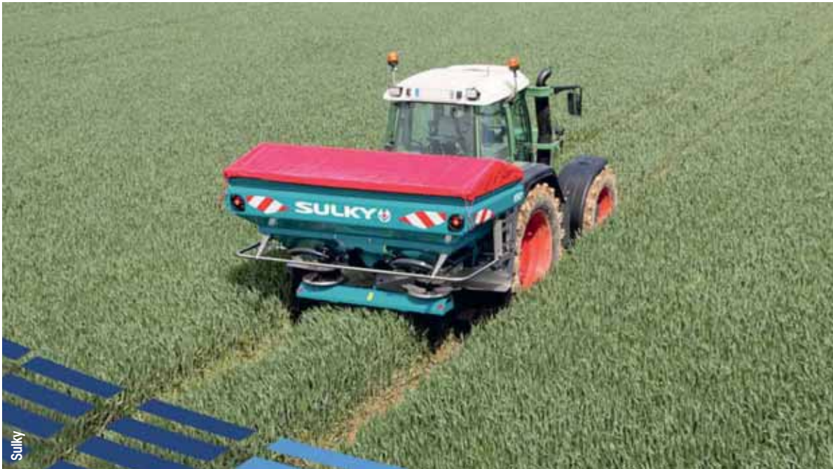
Sulky adotta un software in grado di variare gli stadi su una linea curva, per adattarsi meglio alla realtà della distribuzione centrifuga
