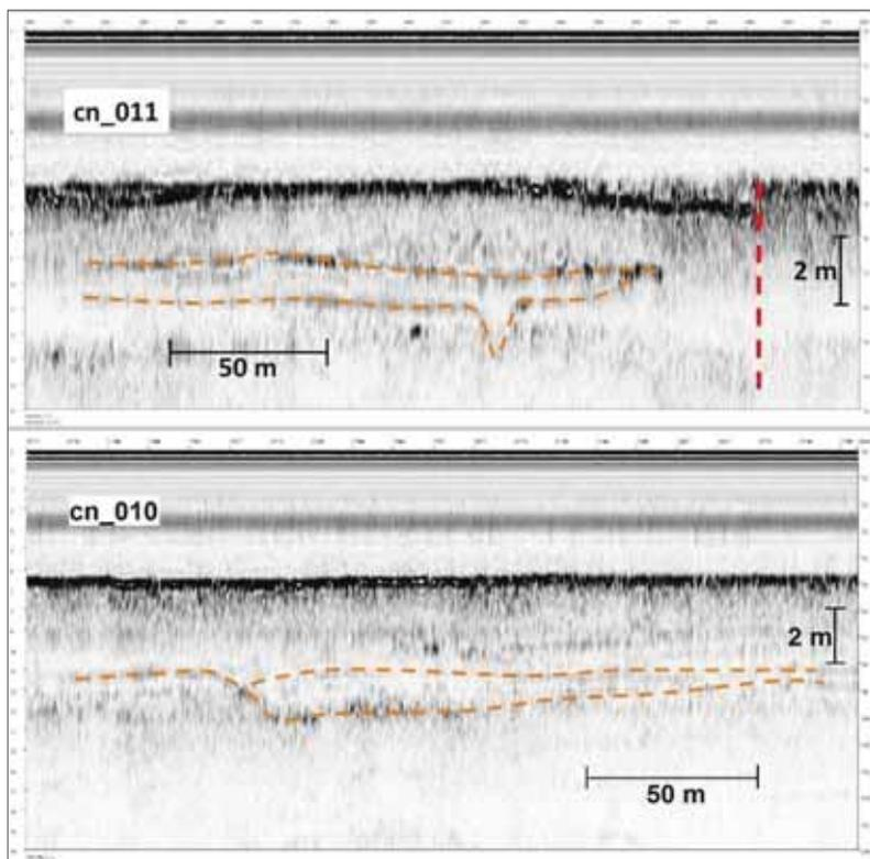
*In alto, strisciata ecografica a scansione laterale del fondale del Cavo Napoleonico in corrispondenza di alcune rotture forse causate dal sisma del 2012. Sopra, profilo sismico a riflessione di un tratto del Cavo Napoleonico, con evidenziati i paleo-alvei fluviali sepolti*
