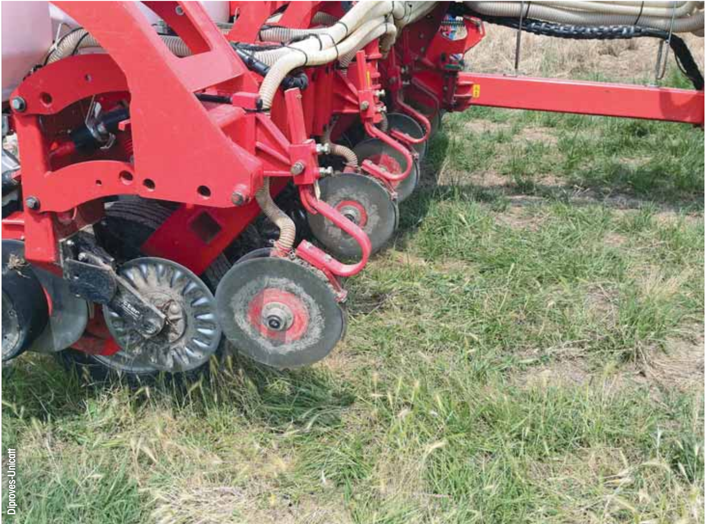
Particolare degli elementi meccanici di una seminatrice da sodo
