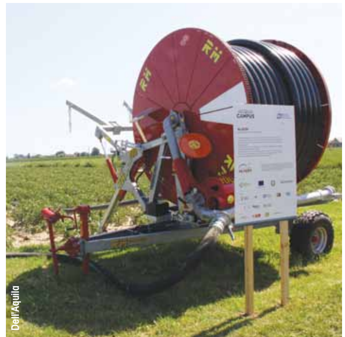
Prototipo di rotolone con barra irrigatrice a rateo variabile
