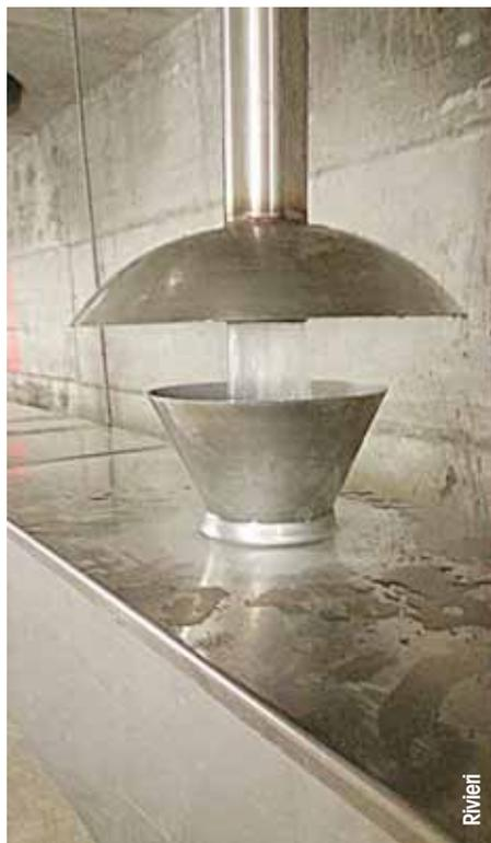
Scarico della condensa dal fondo di una caldaia di cottura
