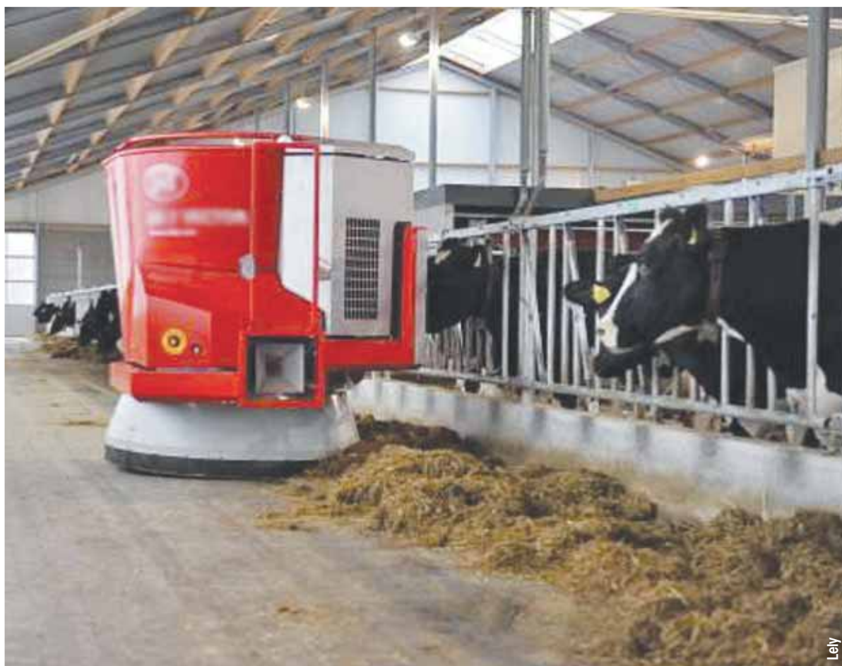
Carro distributore automatico semovente con lettura ottica della razione residua
