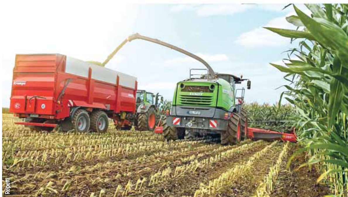
Nella Fendt Katana il quantimetro di serie misura il volume di trinciato scaricato
