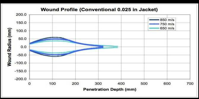
Palla tradizionale di tipo Soft Point con mantello di spessore standard 8,9 decimi di mm. Da notare l'eccellente profondità di cessione raggiunta a bassa VR.
