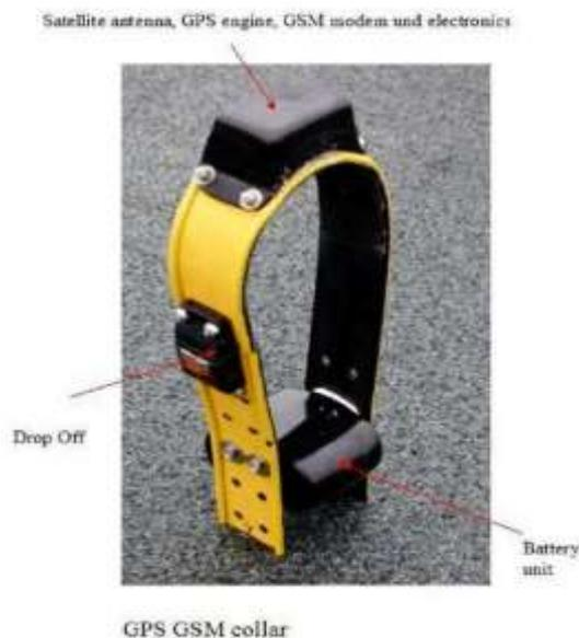
**Figura 4. Il collare GPS/GSM Pro-Light4 (Vectronic Aerospace®)**
