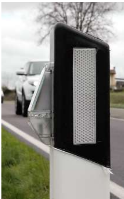
1.7.2-F5 Il dissuasore elettronico (acustico-visivo) utilizzato a Piacenza e Reggio Emilia. A sinistra posizionato su marginate stradale; a destra si notano il pannello solare (A), il led luminoso in funzione (B) e il microfono (C).
