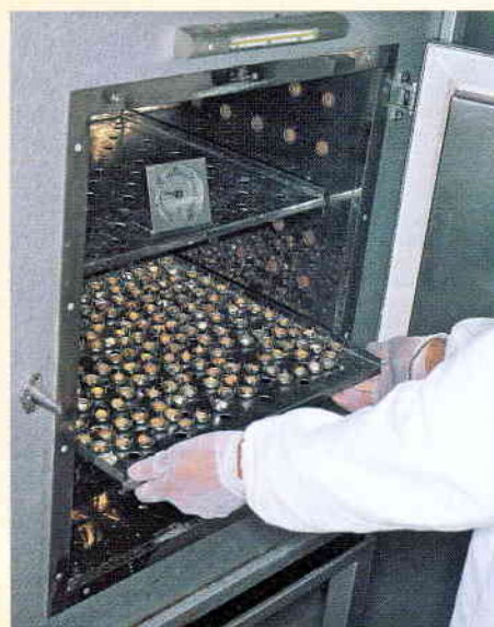
Figura 81 - Essiccazione dei cristallini in stufa da laboratorio.
