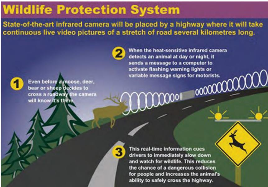
**Fig. 5.8.** Schema di funzionamento di sistema di allarme munito di sensori (fonte: [www.wildlifeaccidents.ca](http://www.wildlifeaccidents.ca))
