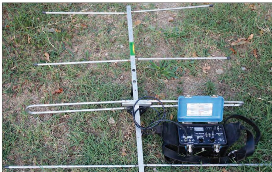
**Fig. 3.8.** Attrezzatura per il radiotracking in frequenza VHF: antenna direzionale (Yagi a 4 elementi) e radio ricevente collegati da cavo coassiale
