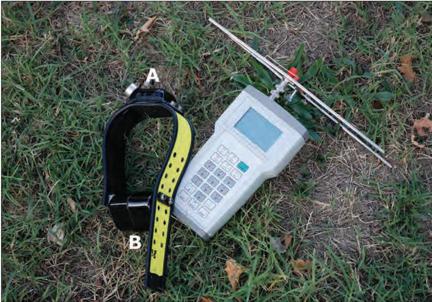
**Fig. 3.10.** Radiocollare GPS (A: dispositivo ricevente; B: batterie) e terminale portatile utilizzati nel presente studio
