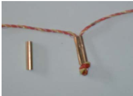
Figura 7.3 - Guaina metallica di congiunzione (Foto Andrea Marsan).
