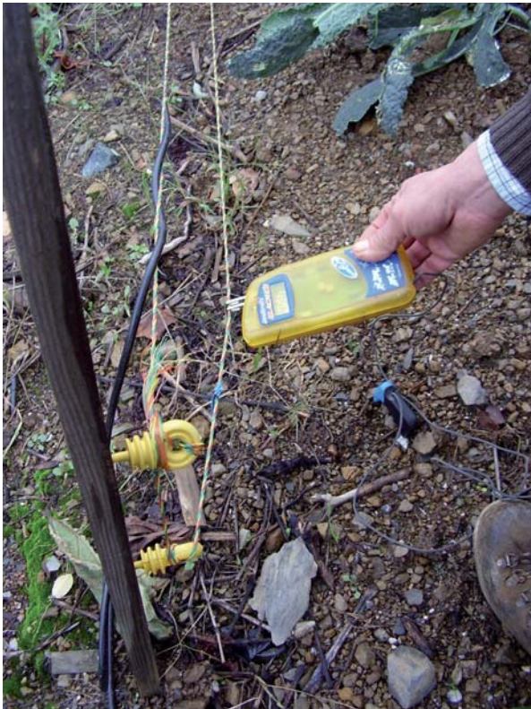
Figura 7.7 - Misuratore di energia (Foto A. Monaco).
