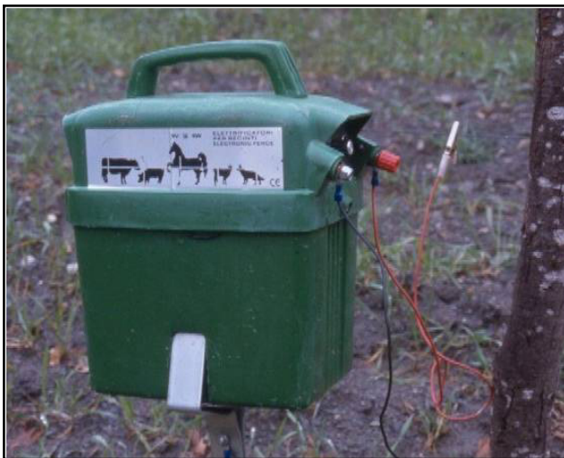
Foto 6.9. Elettrificatore per recinzione elettrificata (Nicoloso S.).
