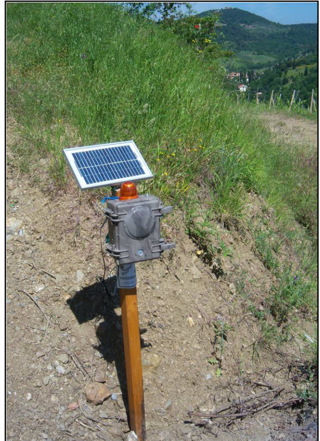
Foto 6.16. Dissuasore ottico-acustico con pannello solare (Roghi M.).
