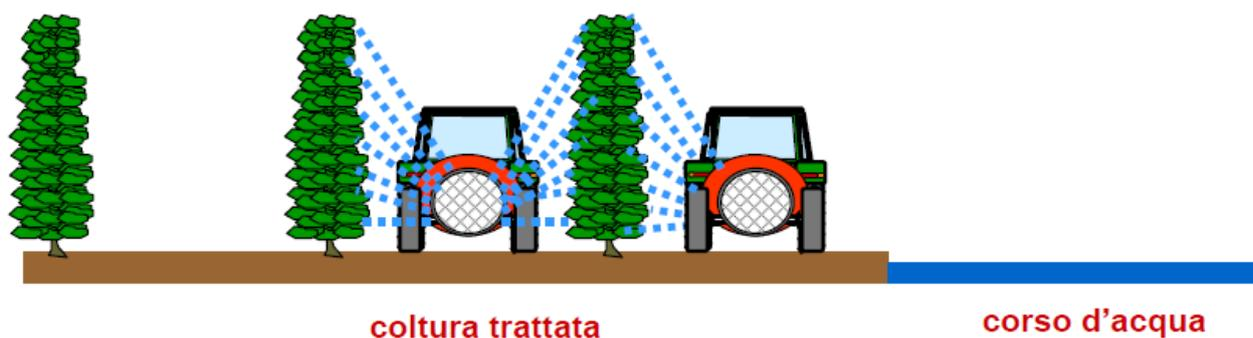
L'irrorazione dell'ultimo filare solo verso l'interno consente di ridurre la deriva almeno del 35%
