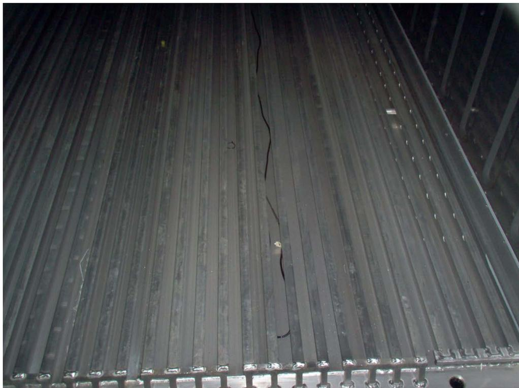
I sensori vanno posti nella posizione corretta e protetti nel fondo del pavimento del container.
