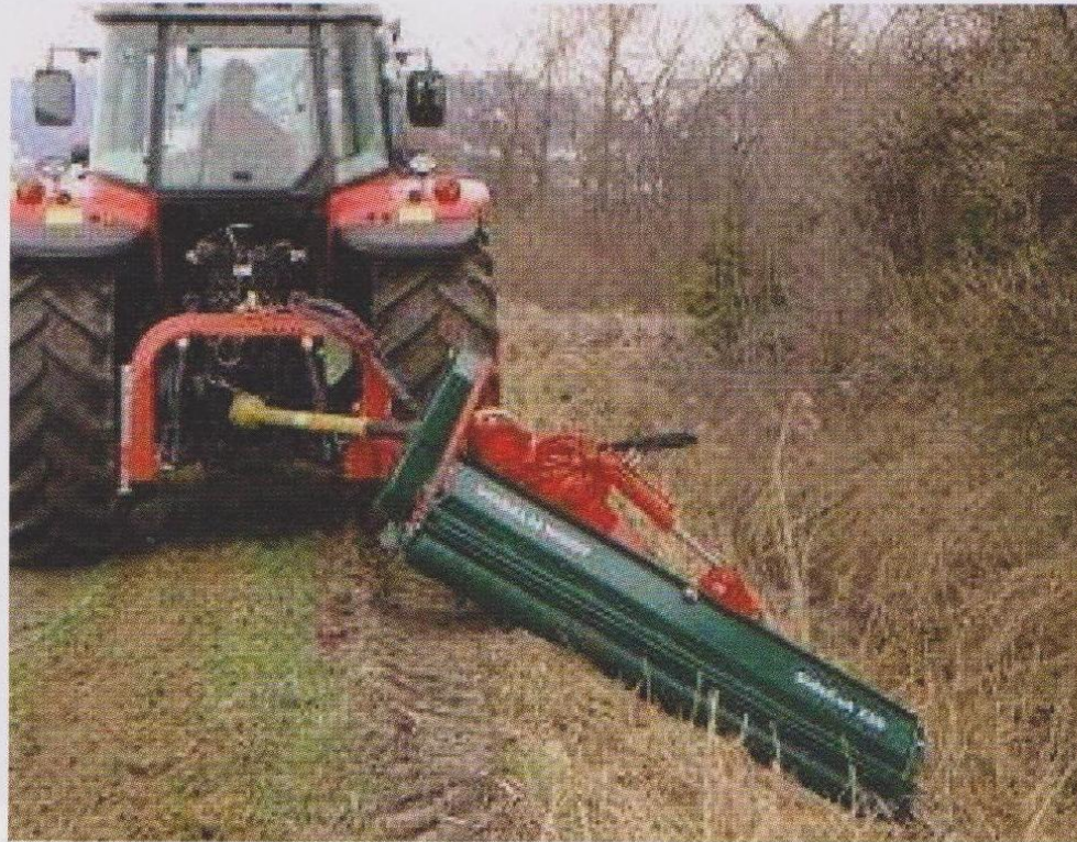
Figura 7.8: macchina per falciare e trinciare la vegetazione sulle fasce spondali e le scarpate dei canali. Il materiale di risulta rimane in posto.
