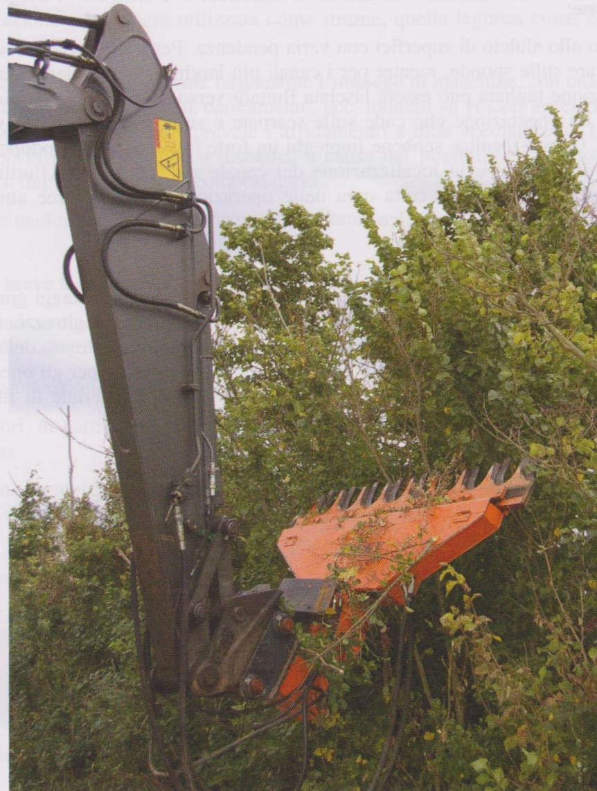
Figura 7.5: barra falciante a azione frontale per il taglio di vegetazione arborea (fino a 5-10 cm di diametro).
