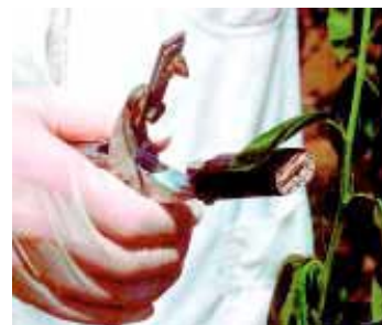
Foto 2 - Pinza speciale usata per praticare ferite simulanti colpi di grandine sulle foglie
