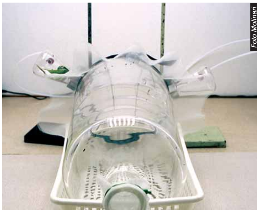
Foto 2 Olfattometro per la valutazione dell'attrattività di sostanze volatili.
