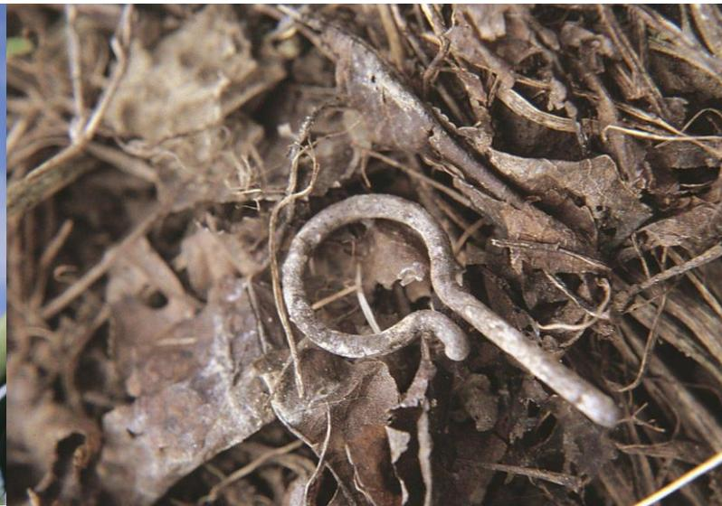
Fig. 8. Erogatore Ecodian in degradazione dopo sei mesi dall'installazione (foto B. Accinelli)
