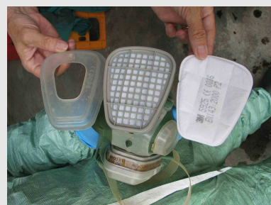
Filtro antipolvere a feltro da fissare sul sottostante filtro marrone, per mezzo di una ghiera (Foto Cons. Fito. Reggio Emilia)
