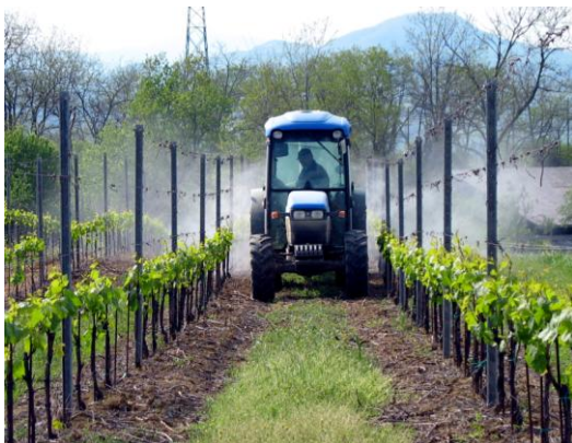
Fig. 5. Esempio di deriva derivante da uso improprio dell'irroratrice (foto L. Casoli)
