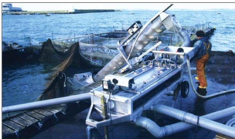
Foto 21 - Operazione di calibratura in un allevamento in gabbie; in evidenza il selezionatore servito da una pompa a vite di Archimede. (Fonte: Faivre).
