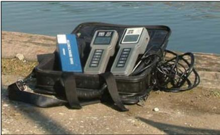
*Foto 7 - Strumentazione adottata per la misurazione dei parametri dell'ossigeno, della temperatura e del pH.*
