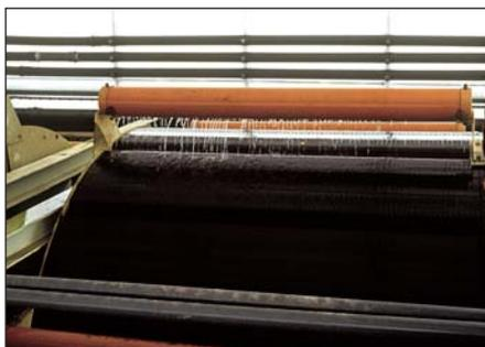
Foto 19 - Vaglio rotativo; in evidenza il sistema di lavaggio in controcorrente.
