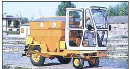
*Foto 26 - Alimentatore semovente per distribuzione meccanizzata a bordo vasca. (Fonte: Milanese).*
