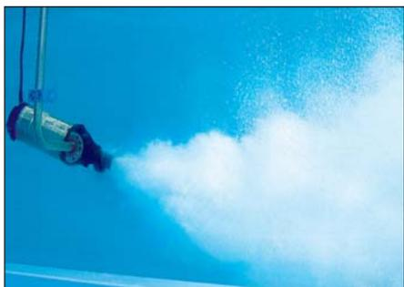
Foto 18 - Pompa a elica aspiratrice in funzione. (Fonte: Aqua&co).
