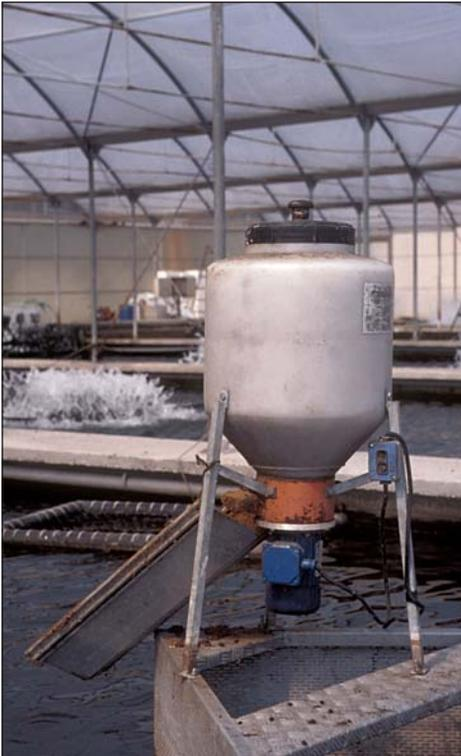
*Foto 23 - Alimentatore dotato di dispositivo distributore azionato da motore elettrico.*
