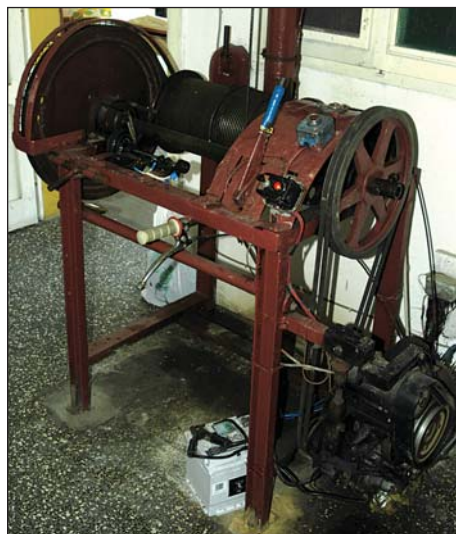
Sistema di sollevamento a motore a scoppio nel capanno di Bruno Trioschi sul fiume Lamone.
