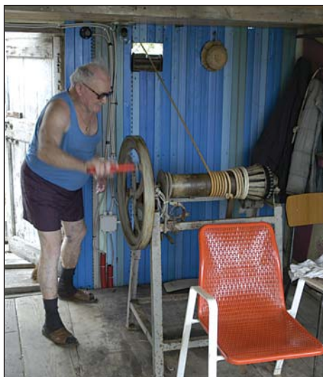
Sistema di sollevamento manuale della rete nel capanno di Natalino Alberi sul Canale Pallotta.
