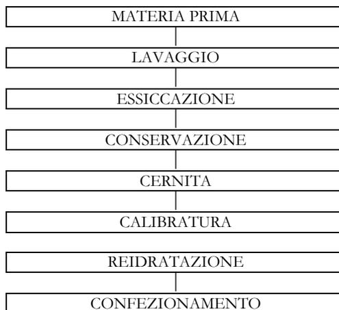
Esempio di diagramma di flusso di produzione di prugne essiccate e principali controlli e registrazioni.
