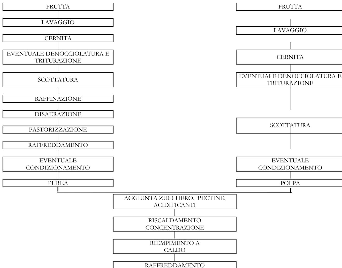
Esempio di diagramma di flusso di produzione relativo a confetture e principali controlli e registrazioni.
