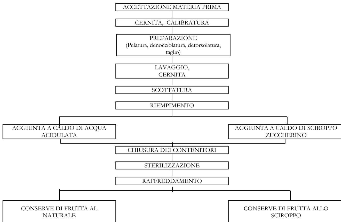
Esempio di diagramma di flusso di produzione di conserve di frutta appertizzate e principali controlli e registrazioni.
