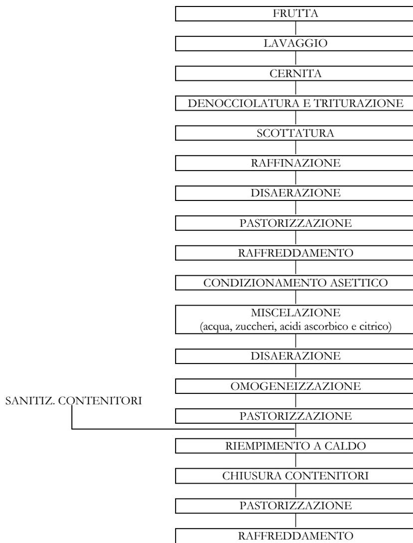
Esempio diagramma di flusso produzione di nettari polposi e principali controlli e registrazioni.
