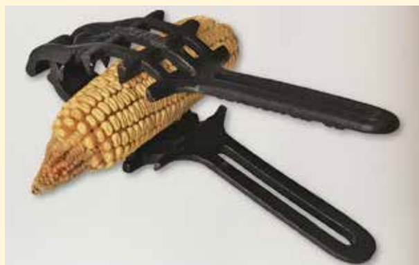
Fig. 51: Un funzionale attrezzo per sgranare le pannocchie di mais (tratto da: Mangiare ai tempi della fame , Parco Nazionale delle Foreste Casentinesi).
