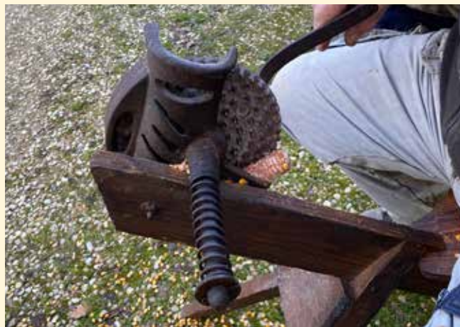
Fig. 55 e 56: Sgranatura manuale del mais tramite sgranatore a manovella, realizzata a scopo dimostrativo dal sig. Luigi Franzoni di Tebano di Faenza (RA), che conserva molti strumenti nel suo museo privato.
