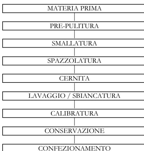
Esempio di diagramma di flusso di produzione di noci fresche in guscio e principali controlli e registrazioni.
