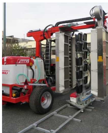
Controllo funzionale e regolazione strumentale di un'irroratrice a tunnel con recupero
