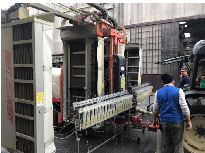
Controllo funzionale e regolazione strumentale di un'irroratrice a tunnel con recupero
