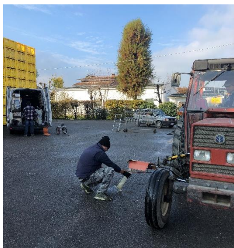
Controllo funzionale e regolazione strumentale di una barra per sottofila schermata
