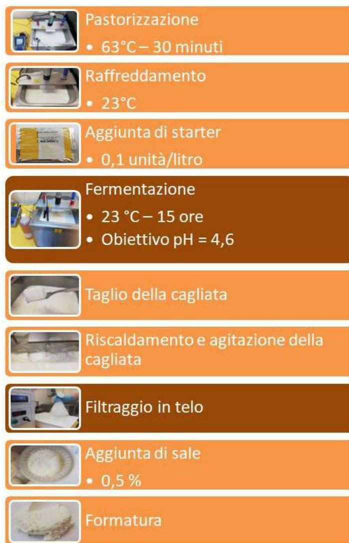
**Figura 5:** processo a scala sperimentale del formaggio a pasta acida
