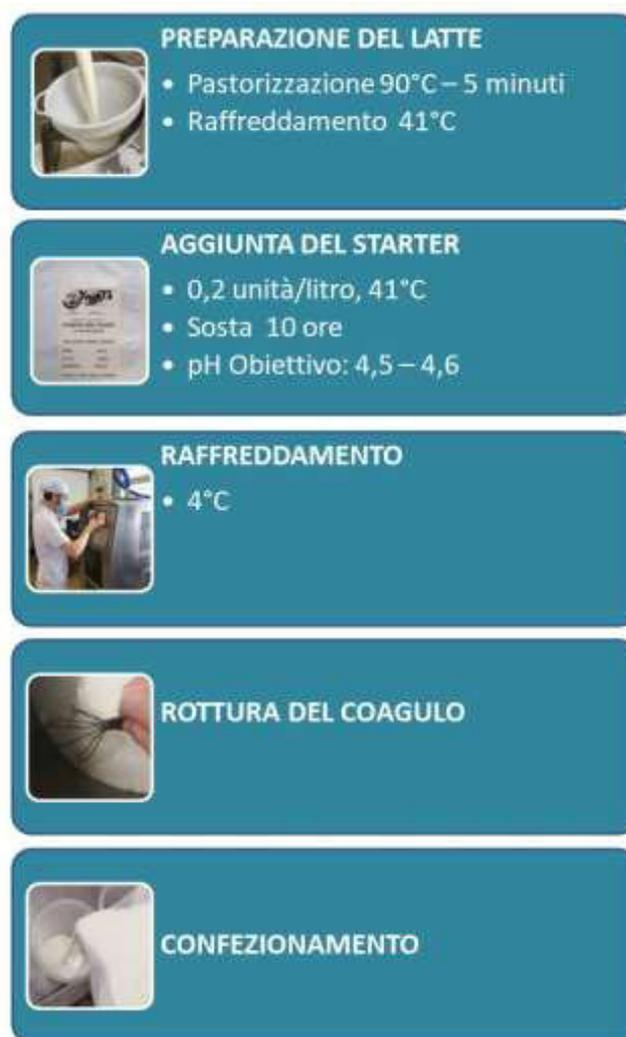
**Figura 8:** Schema del processo di produzione di yogurt
