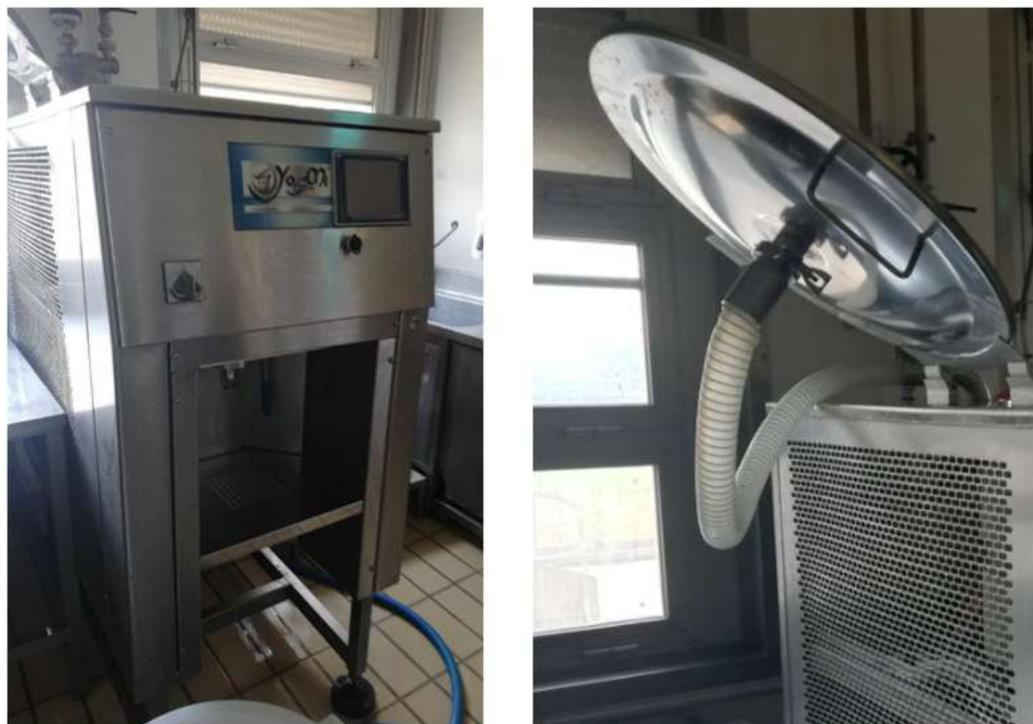
**Figura 10:** Macchina Yo&Mi con capacità tra 20 e 60 litri e dettaglio del dispositivo per la concentrazione e deodorizzazione del latte
