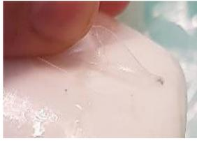
Figura 11: Delaminazione delle vaschette trattate con HPP
