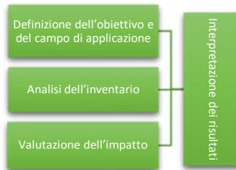
*Figura 211: Fasi di una LCA*
