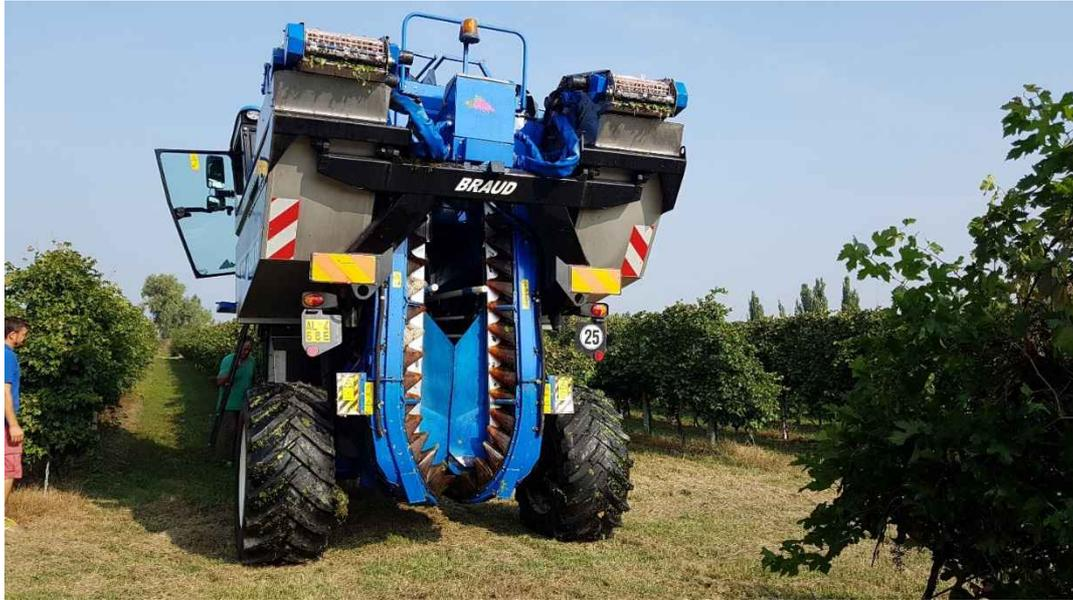
**Figura 59: Raccolta meccanizzata di Lambrusco az. Agricola Tardini – Particolare della vendemmiatrice meccanica utilizzata.**
