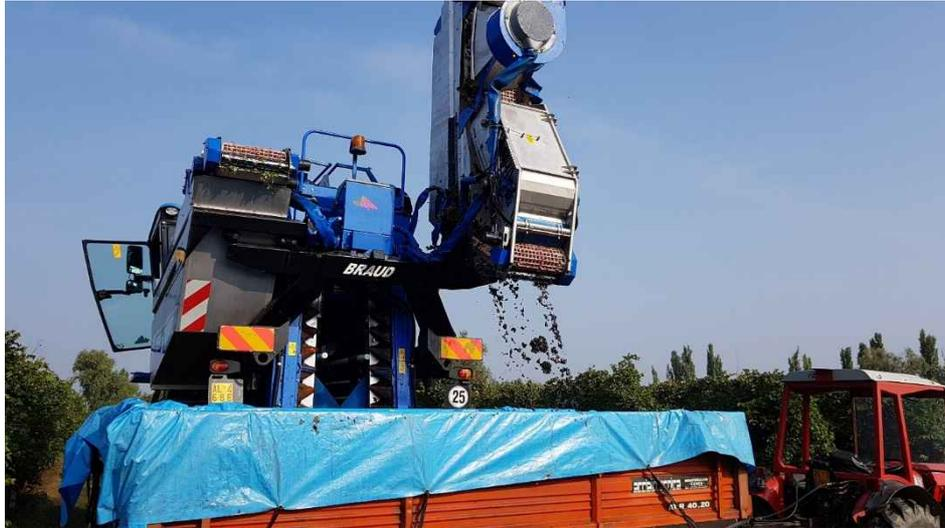
**Figura 57: Raccolta meccanizzata di Lambrusco az. Agricola Tardini – Fase di svuotamento delle tramogge di raccolta della vendemmiatrice meccanica utilizzata.**
