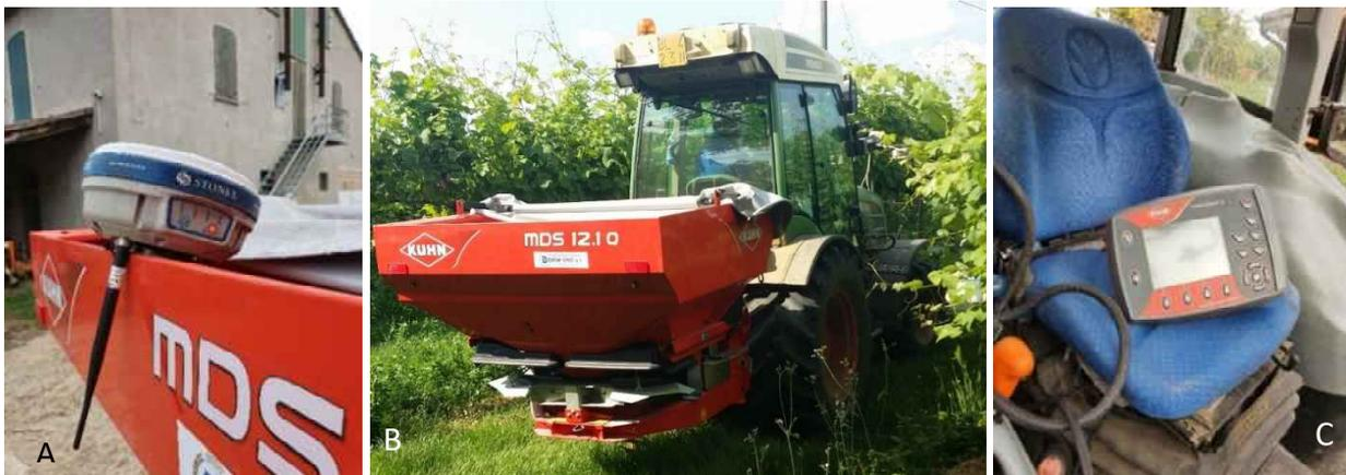
**Figura 24** Applicazione a rateo variabile del fertilizzante tramite spandiconcime Kuhn. A, particolare del ricevitore STONEX con antenna GNSS integrata; B, centralina elettronica di controllo dello spandiconcime; C, macchina in lavoro in campo allestita con deviatori per la localizzazione del fertilizzante a bande in prossimità delle piante.
