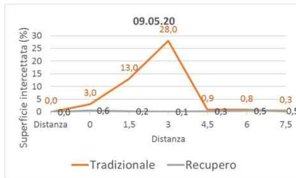
Figura 20. Misura della miscela dispersa; superficie intercettata della miscela erogata (%) sulle cartine idrosensibili disposte sul terreno lateralmente al filare trattato in corrispondenza di un singolo passaggio (ZONA PS).
