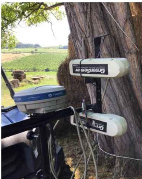
Figura 23. Radiometri attivi Greenseeker utilizzati per le misure di vigore vegetativo.
