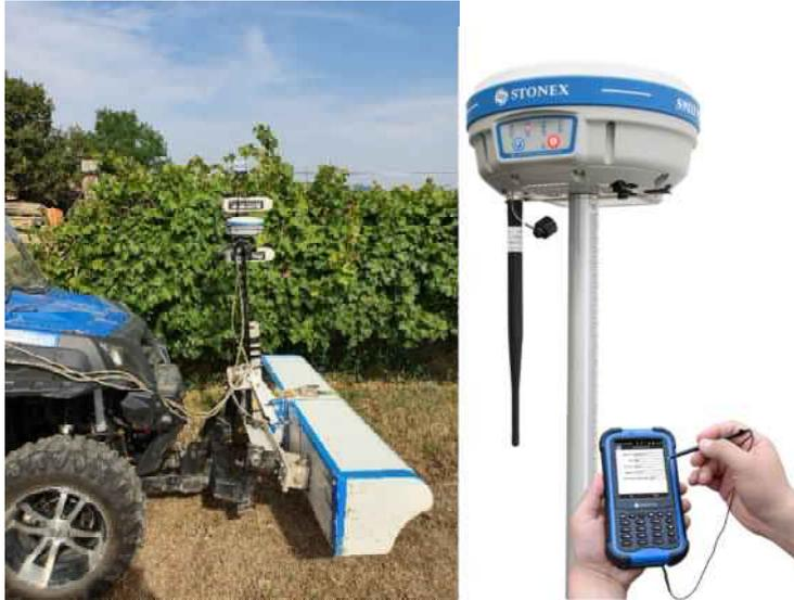
Figura 22 Sensore Top Soil Mapper (EMI sensor) per la misura della conducibilità elettrica applicato anteriormente al veicolo quad. A destra ricevitore GNSS e datalogger STONEX.
