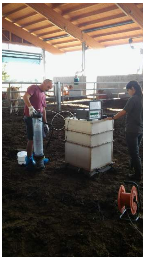
Figura 3.25 – Camera di saturazione utilizzata per il rilievo delle emissioni della lettiera
