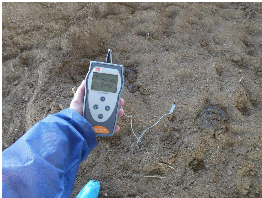
Figura 3.6 – Misura della temperatura della lettiera con termometro digitale con sonda a penetrazione
