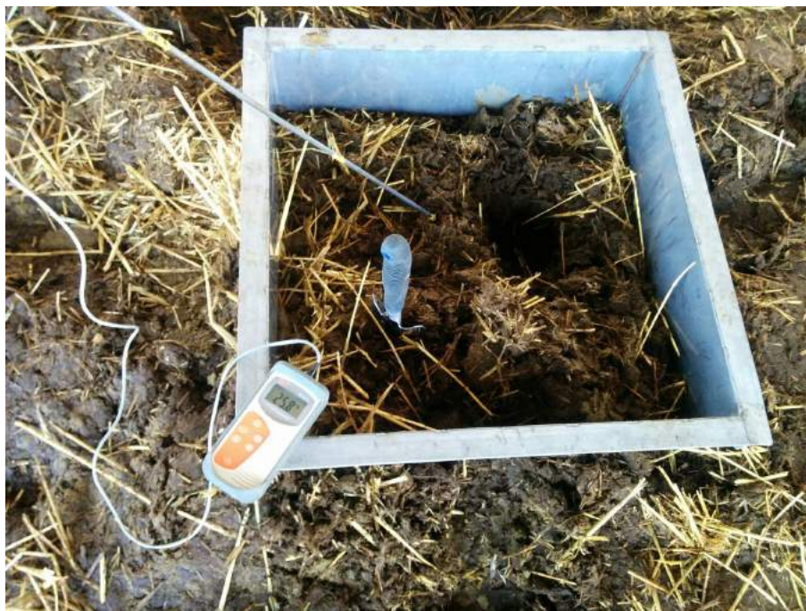
Figura 3.24 – Telaio di base in acciaio inox della camera di saturazione utilizzata per il rilievo delle emissioni della lettiera.
